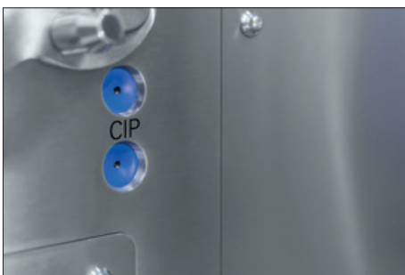
CIP清洗接口
